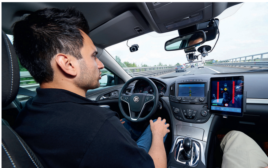
Level 2+-System coASSIST: ZF liefert das komplette System, einschließlich Mobileyes EyeQ Kamera. Zukünftig wird auch der neue ZF Medium-Range Radar in dem System erstmals zum Einsatz kommen. © ZF
