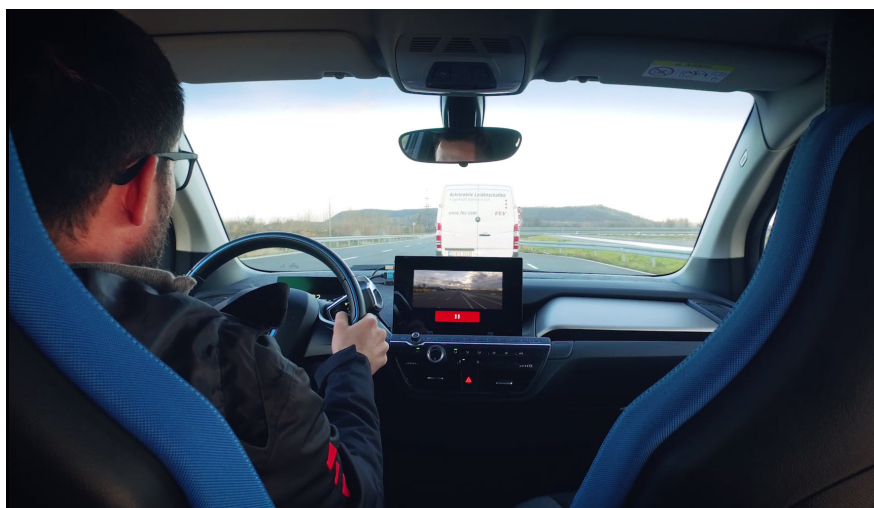
Bild 1: Mittels V2V-Vernetzung werden die Frontkameras zweier hintereinanderfahrender Fahrzeuge so miteinander verbunden, dass der Fahrer im nachfolgenden Fahrzeug sieht, was sich vor dem ersten Fahrzeug befindet. © FEV
