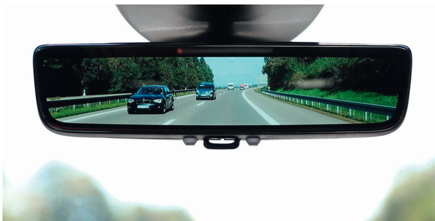
Bild 2: Der Full Display Mirror von Gentex spielt eine zentrale Rolle bei den Kameraüberwachungssystemen. © Gentex
